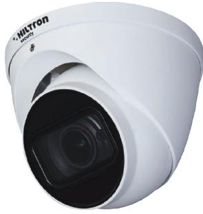
Sensore di immagine CMOS da 4 MP, 1/3 ", basso illuminamento, alta definizione dell'immagine
