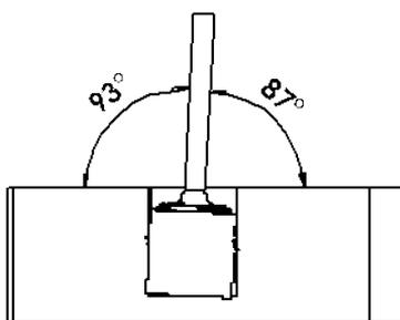
**Posizionamento corretto mediante regolazione inserti.**
