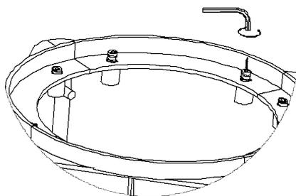
Il posizionamento deve avvenire in modo perpendicolare al terreno. Qualora la base non sia perfettamente livellata è possibile fare piccoli aggiustamenti attraverso la regolazione degli inserti sul pozzetto. Allentando l'inserto sull'opportuno lato da correggere si ottiene l'innalzamento della relativa base Parvis o Mana fino all'ideoneo allineamento.
