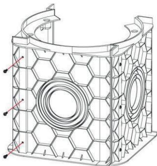
Allargare le due pareti opposte per permettere l'inserimento ad incastro dell'ultimo lato del pozzetto
