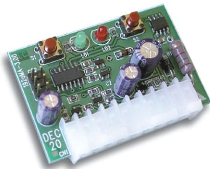
Le DEC20 est un decodateur à deux chaînes pour antenne de réception indiqué pour les centraux de automatisme PCM1, PCM10F, PCM10S, PCM20, PCM30.
