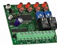
Il DX2000 è un decoder bicanale rolling code associato al ricevitore BIRD completo di antenna. Il decoder è dotato di due relè in uscita pilotati dai quattro pulsanti (canali A, B, C e D) del radiocomando QUAD.
