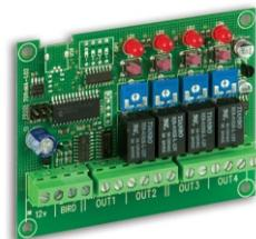
Il DX4000 è un decoder quadricanale rolling code associato all'antenna con ricevitore BIRD dotato di quattro relè in uscita pilotati dai quattro pulsanti (canali A, B,C e D)del radiocomando QUAD. **La scheda DX4000 puo' programmare da 1 a 1400 telecomandi QUAD**
