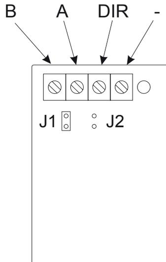
J1: inserire il jumper se il modulo è connesso alla fine della linea.
